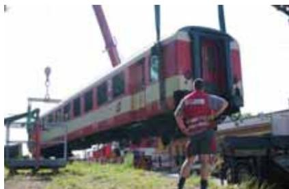
Mit Feuerwehrkränen wurde der 23 Tonnen schwere Eisenbahnwaggon auf den Tieflader verladen
