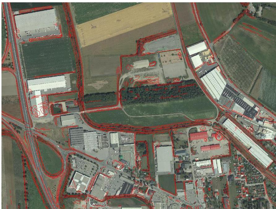
Abbildung 1: Implementierte Bruchkanten (Ausschnitt)
