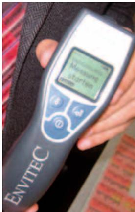
Das neue Alkomat-Vortestgerät
